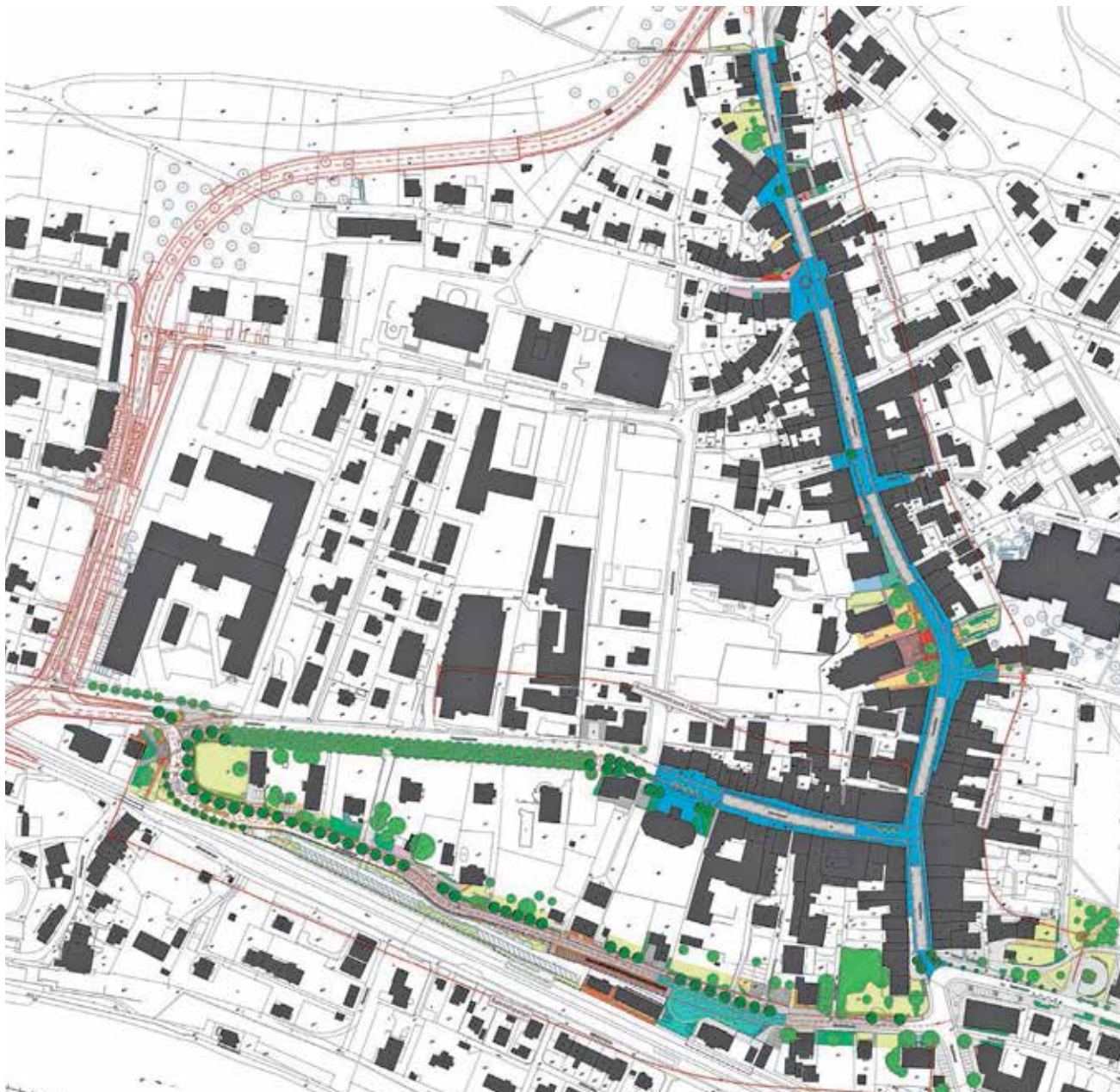
Mit der Ostumfahrung (rot) wird der Durchfahrtsverkehr aus dem mittelalterlichen Flecken Bad Zurzach verschwinden. Die heutige Hauptstrasse, die Schwertgasse und die Promenadenstrasse werden von einer Kantonsstrasse zu einer Gemeindestrasse. Das bietet die Chance, das Herz von Bad Zurzach mit verschiedenen Massnahmen aufzuwerten.
